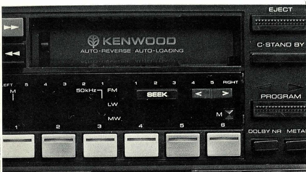
Nella foto grande: i tasti che controllano alcune delle funzioni 'esclusive' del KRC 1022. Sopra: i comandi per la direzione del nastro. Un solo motore si occupa di tutti i movimenti necessari
